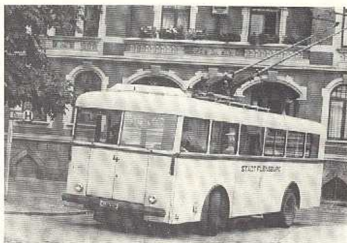
Abb. 16: Obus 4, Henschel/Schumann/SSW, Baujahr 1944 in der bekannten eckigen Kriegs-Einheitsbauweise mit zwillingsbereifter Vorderachse.
