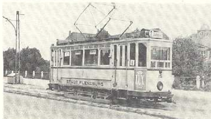
Abb. 2: Tw 15 der zweiten Lieferung 1912 (12-23) mit nachträglich geschlossenen Plattformen, Busch/AEG, 18 Sitzplätze (in Abteilanordnung), 33 Stehplätze, Länge: 8350 mm, Achsabstand: 1800 mm, Breite: 2000 mm.
